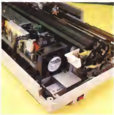
L'alimentatore è posizionato nella parte posteriore della stampante e comprende un ventole di raffreddamento.
